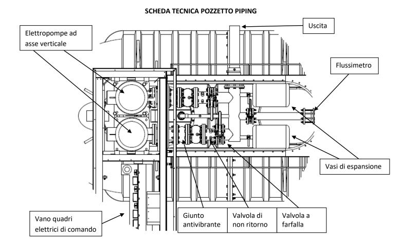
Pozzetto piping e valvole di regolazione da interro, realizzato di polietilene e rinforzato con struttura in acciaio, coperchio pedonabile in acciaio coibentato REI 60 completo di:
